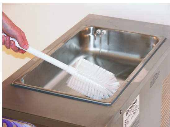
Figura 3-3 Higienización del depósito
